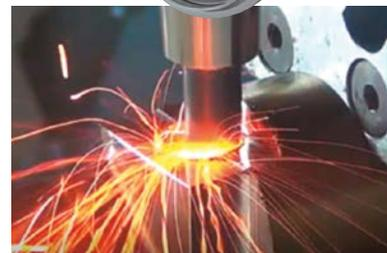
Le frese integrali in ceramica sono in grado di lavorare le leghe resistenti al calore utilizzate nei motori, che non possono essere lavorate ad alta velocità con gli utensili in metallo duro esistenti a causa del calore generato durante la produzione.
