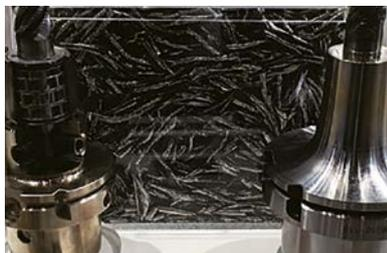
Per quanto riguarda la lavorazione della lega di titanio, un materiale speciale utilizzato nella produzione di velivoli, le frese integrali e le frese a inserti - la cui velocità di rimozione del materiale al minuto (MRR) supera i 300 m<sup>3</sup>/min - consentono di eseguire la rimozione di materiale su larga scala in breve tempo.
